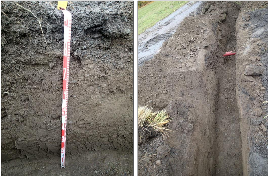
Tien poikkileikkaus 2. Vasen. Tiekerrokset tien poikkileikkauksessa. Oikea. Ojan etelälaidalla ehjimmät tiekerrokset, pohjoisreunaa on kaivettu aikaisempien kaapeliasennusten yhteydessä.
